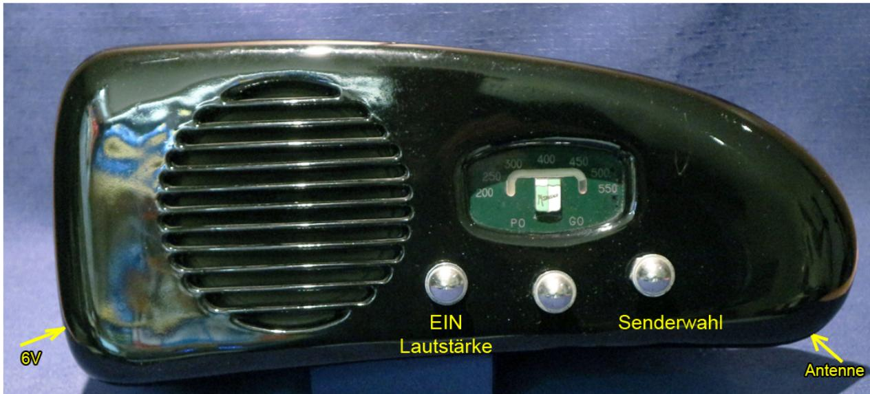
Das Radio trägt die Bezeichnung *Auto-Radio pour Citroën 11 et 15 CV* und hatte ursprünglich die Wellenbereiche LW und MW. Nach der Restaurierung empfängt es **DAB+**.
