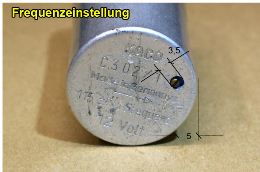
Optimierung der Frequenz für minimalen Eingangsstrom und/oder minimale Trafoschwungung
