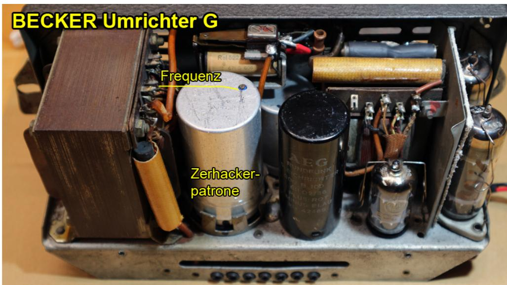
Zum Schluss werden Becher und Unterteil mit Tesafilm zusammen geklebt, in den Umrichter eingesetzt und die Frequenz optimal eingestellt
